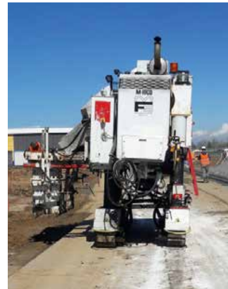
▲ Exemple type d'une machine d'extrusion par vibration.
