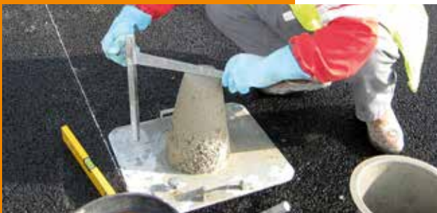
▲ Mesure d'affaissement au cône d'Abrams.
