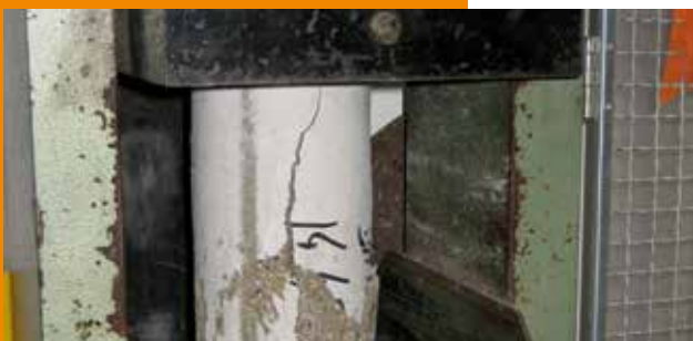
▲ Écrasement d'une éprouvette par compression.
