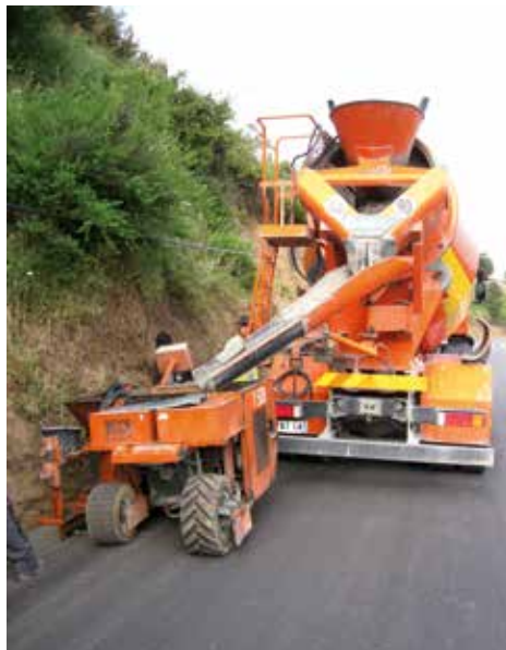
▲ Exemple type d'une machine d'extrusion par vis.
