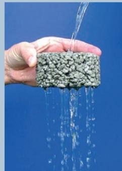
Porosité d'un échantillon de béton drainant.
