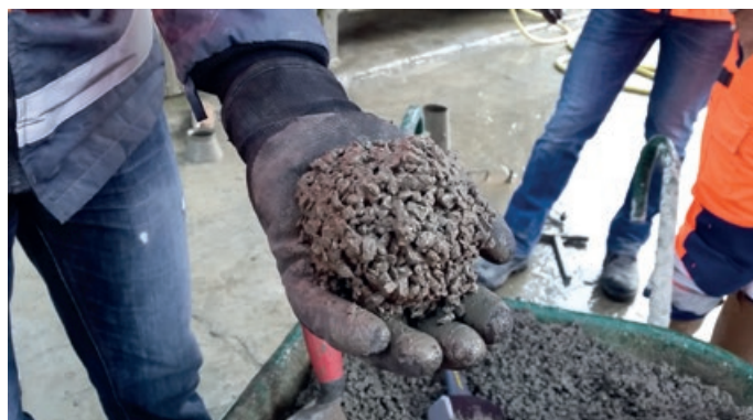
Photo 45 - Consistance du béton drainant : test à la boule.
