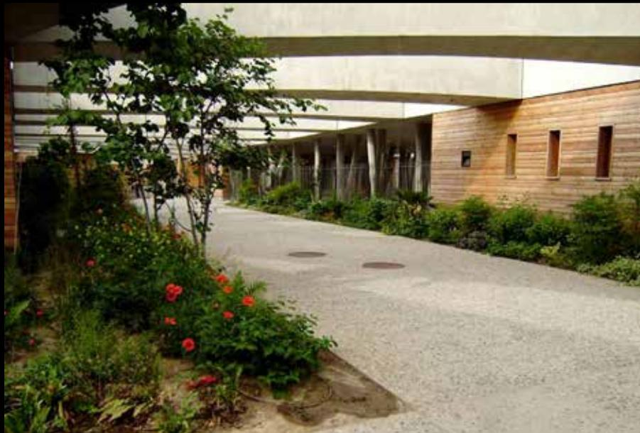
Roland Billet, entreprise Léon Grosse, a sous-traité les bétons d'aménagement. Il souligne qu'il y a eu des remises en question. Le choix du béton désactivé pour les circulations a été déterminé par l'usage. Le maître d'ouvrage souhaitait des surfaces dures non poussiéreuses en lieu et place du stabilisé prévu au marché.
