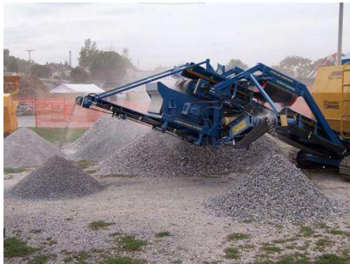
Photo 19 : Concasseur mobile (Crédit photo : RDS France)
