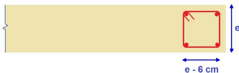
Figure 15 : Chainage sur les bords libres circulés
